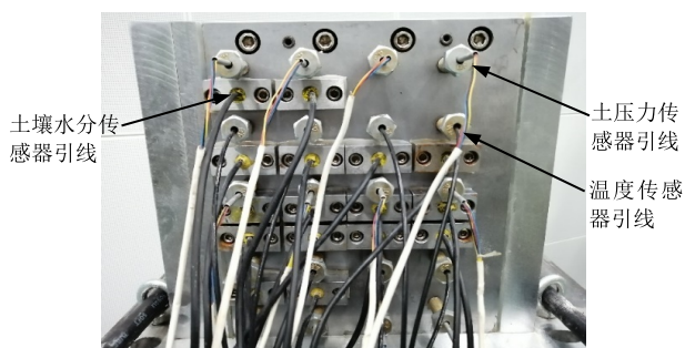
图 5 后 L 形板和传感器引线连接插口
