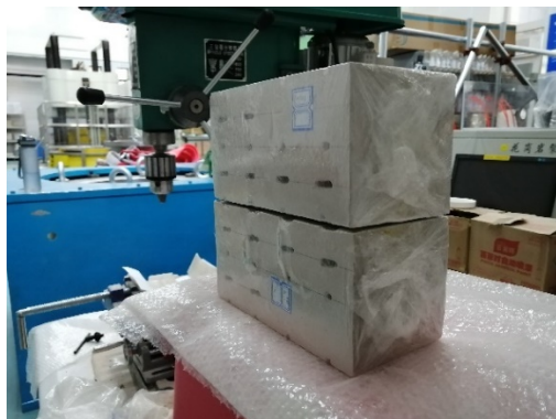
图 8 试验用高压实膨润土砌块试样
